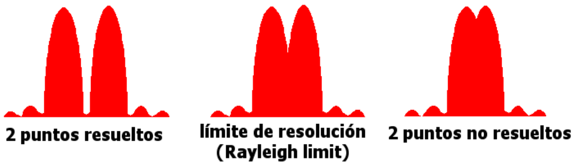
Fig. 7: Poder de resolución: 2 puntos son resueltos, cuando sus patrones de difracción no se solapan (izquierdo), cuando se inician de solapar se alcanza el límite de resolución (centro) y cuando los puntos se solapan no son resueltos (derecho).
